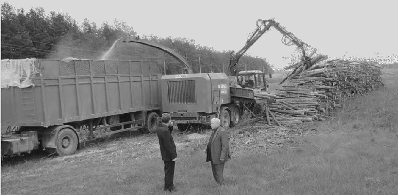
Работа рубительной машины и щеповоза
